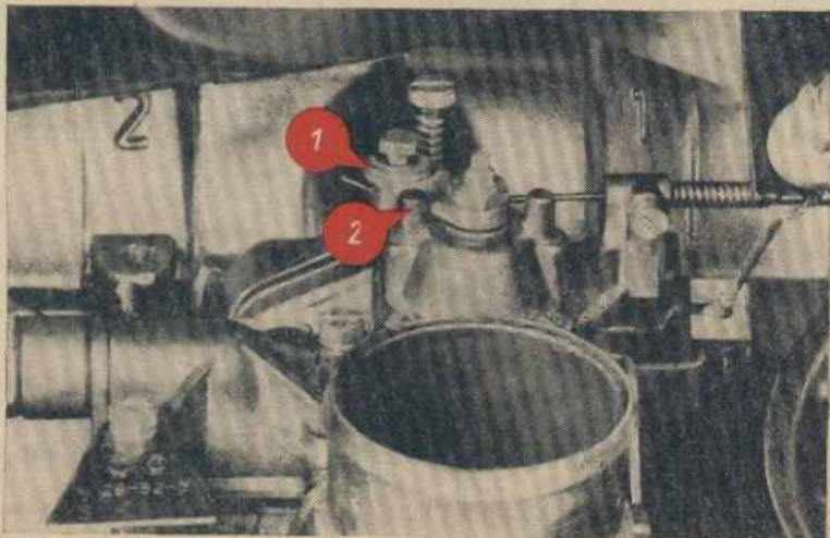
Abb. 34 Hebel des Startvergasers (1) in geschlossener Stellung und Gehäuseanschlag (2)
