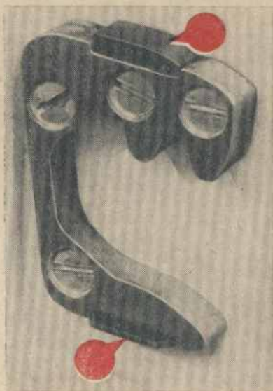
Abb. 73 Schließkeil am Türholm. Die Pfeile zeigen die Gleitstücke aus Kunststoff
