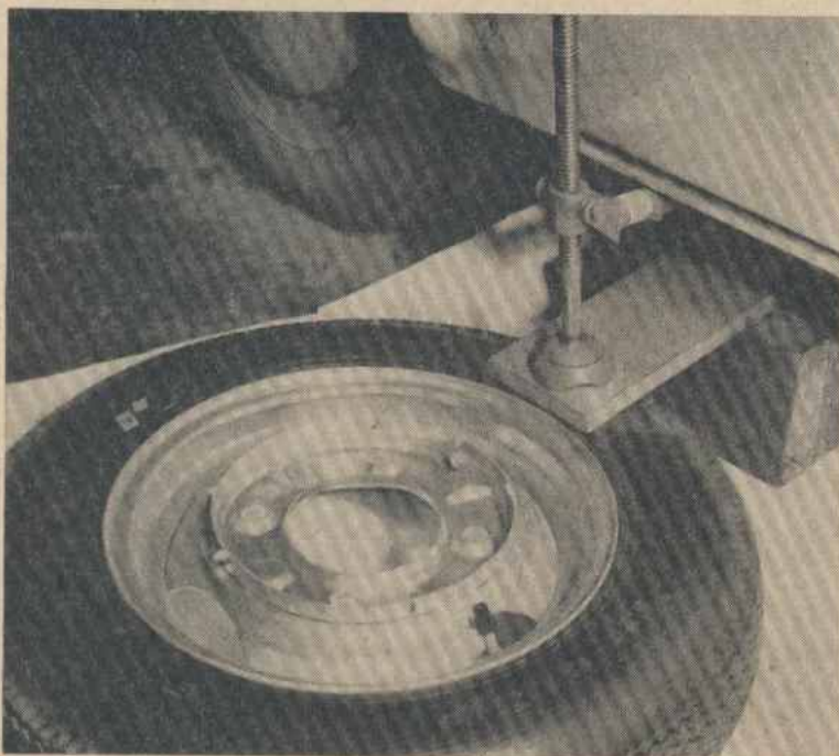
Abb. 70 Abdrücken des schlauchlosen Reifens von der Felgen- schulter
