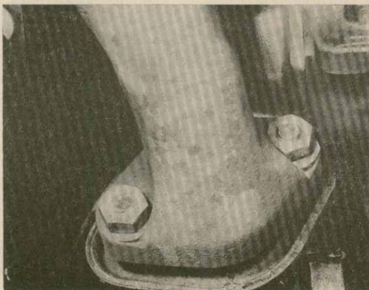
Abb. 20 Verschraubung am Auspuffkrümmer
