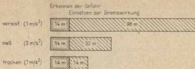
Abb. 3 Bremswege bei 50 km/h in Abhängigkeit vom Fahrbahnzustand
